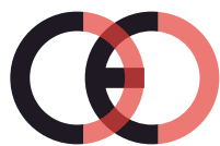
Faux marquage CE (trop proche)
