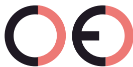
Faux marquage CE (trop éloigné)
